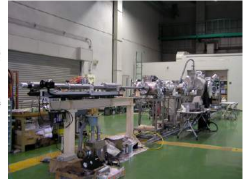
二段式軽ガス銃を用いたパネルへのデブリ衝突実験(宇宙研)
