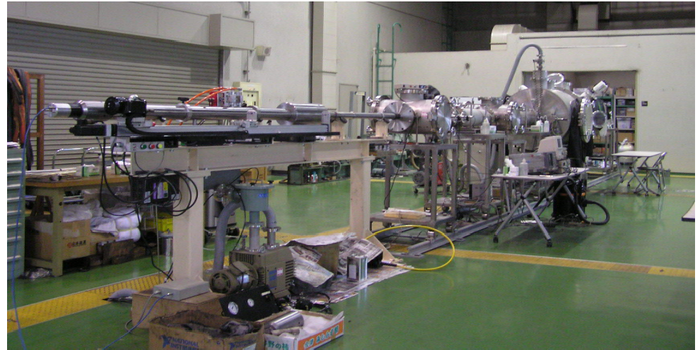
JAXA宇宙科学研究所の超高速衝突実験設備 二段式軽ガス銃(0.3gの物体を秒速5km以上に加速可能)
