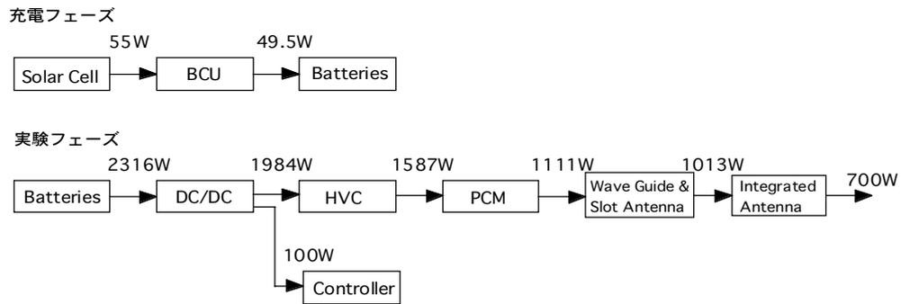
図8 モジュールの電力遷移図
