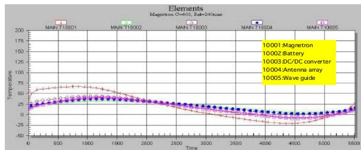
図9 モジュールの各部の温度変化（軌道一周分）
