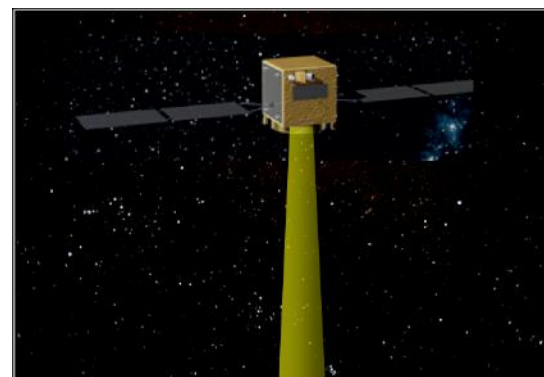
小型衛星から地上へのマイクロ波送電実験。
