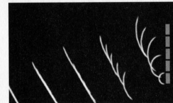
図23 電波を発するタイミングをずらすことで、位相を変えられる
