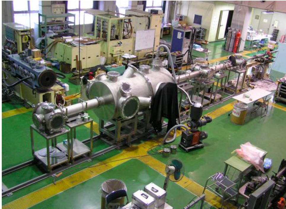
JAXA・宇宙科学研究所にある超高速実験設備(二段式軽ガス銃)
