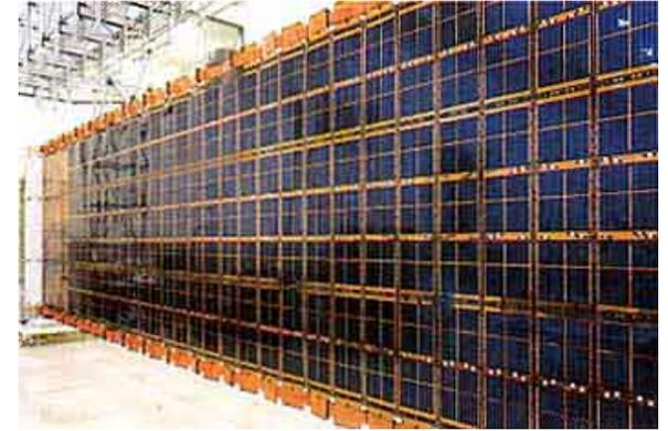
衛星で使われている太陽電池のパネル
