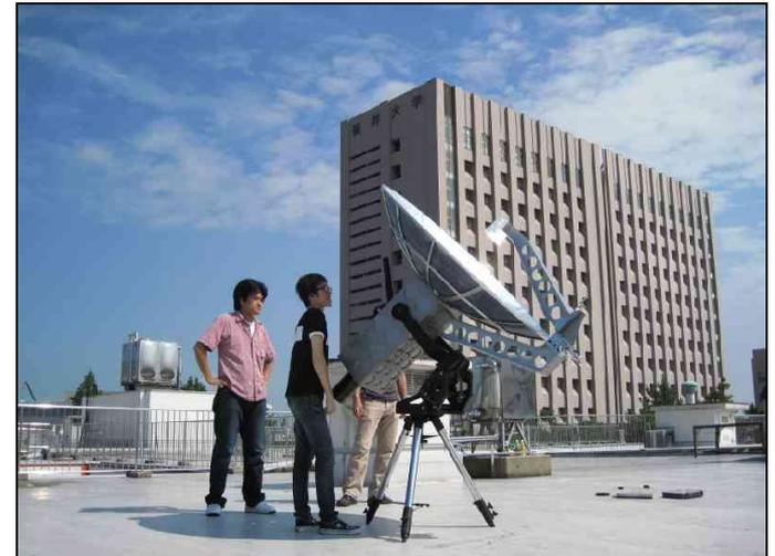
福井大等との共同で実施中の太陽光直接励起レーザー発振実験
