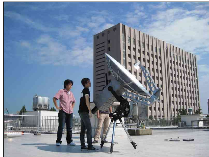
福井大等との共同で実施中の太陽光直接励起レーザー発振実験
