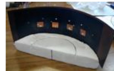
フレキシ基板上のレクテナアレイの試作
