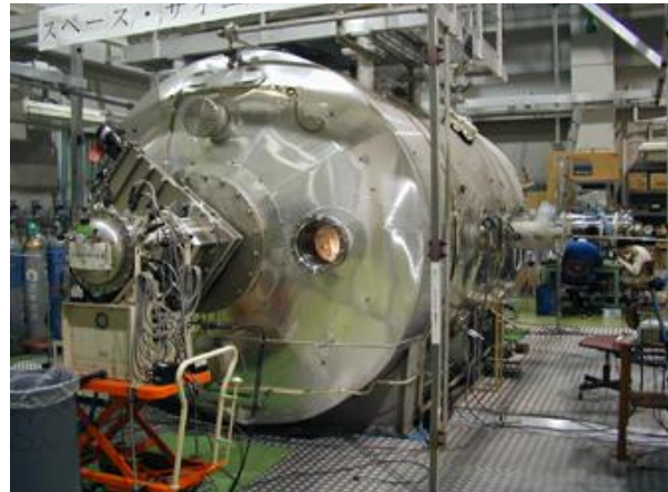
宇宙空間プラズマ模擬試験装置
