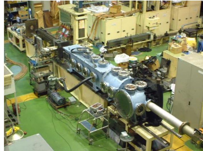
JAXA宇宙科学研究本部の超高速衝突実験設備レールガン
