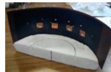
フレキシ基板上的レクテナアレイの試作
