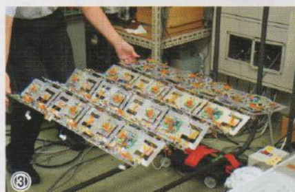
大型の構造物を宇宙へ運搬する方法もSSPSの課題。写真①～④はコンパクトな折りたたみ式のSSPSの展開方法を示したもの
