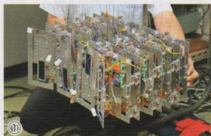
SSPSの宇宙軌道上システムの仕組みをわかりやすく説明した模型。太陽電池パネル(左)の裏側(右2点)には、太陽電池パネルで発電した電力をマイクロ波電力に変換する回路と送電アンテナが装着されている。構成自体はいたってシンプル
