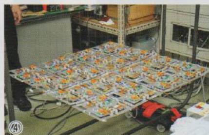
大型の構造物を宇宙へ運搬する方法もSSPSの課題。写真①～④はコンパクトな折りたたみ式のSSPSの展開方法を示したもの
