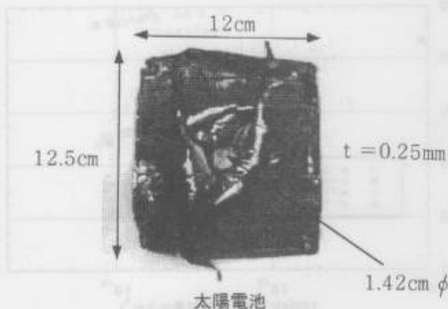
図24 レールガンからの高速弾(約7km/s)をアモルファスシリコン薄膜太陽電池に衝突させた時の破壊の様子。1cmの大きさの弾の衝突に対し1.42cmの穴があき、直径10cm程度の破壊が生じた。
