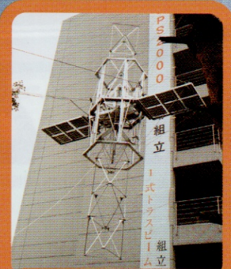
宇宙空間でのSPS組み立てはロボットによって行う。写真は「自動組立装置」を使った組立の様子。
