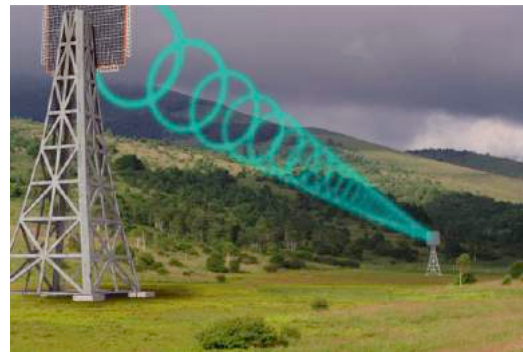
図3 地上のマイクロ波送電実験の構想。約1.6kWのマイクロ波ビームを50m先の受電パネルに送電する。
