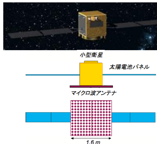
図5 小型衛星を利用したマイクロ波送電実験の構想。
